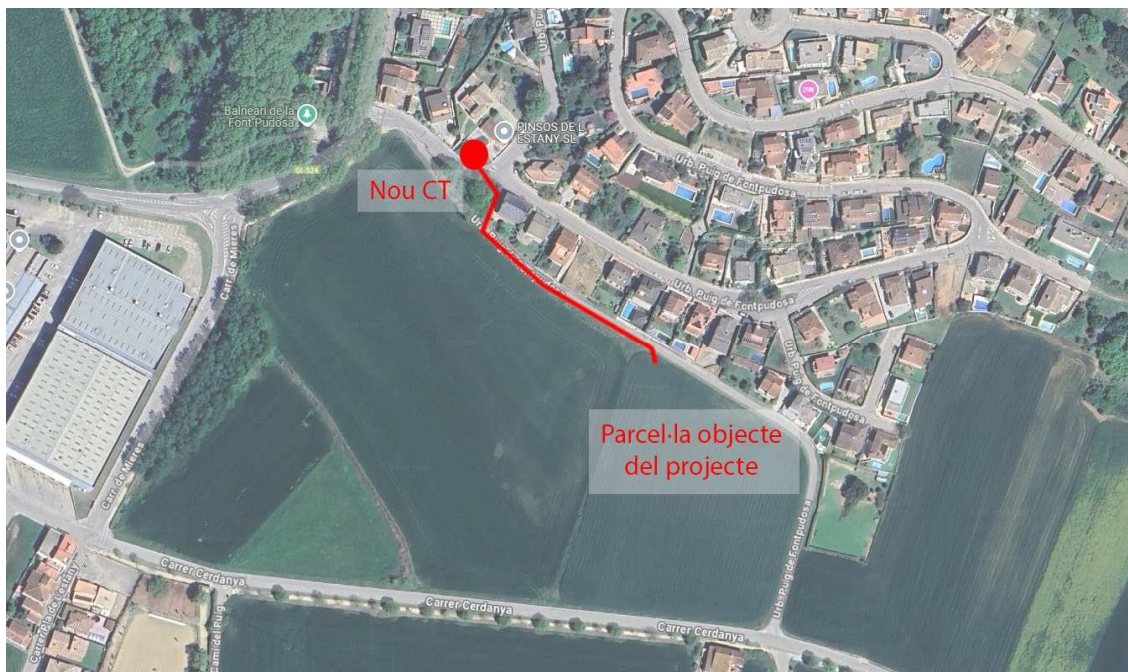
Imatge 23. Ubicació del nou CT i soterrament de la línia (font: PAE)
